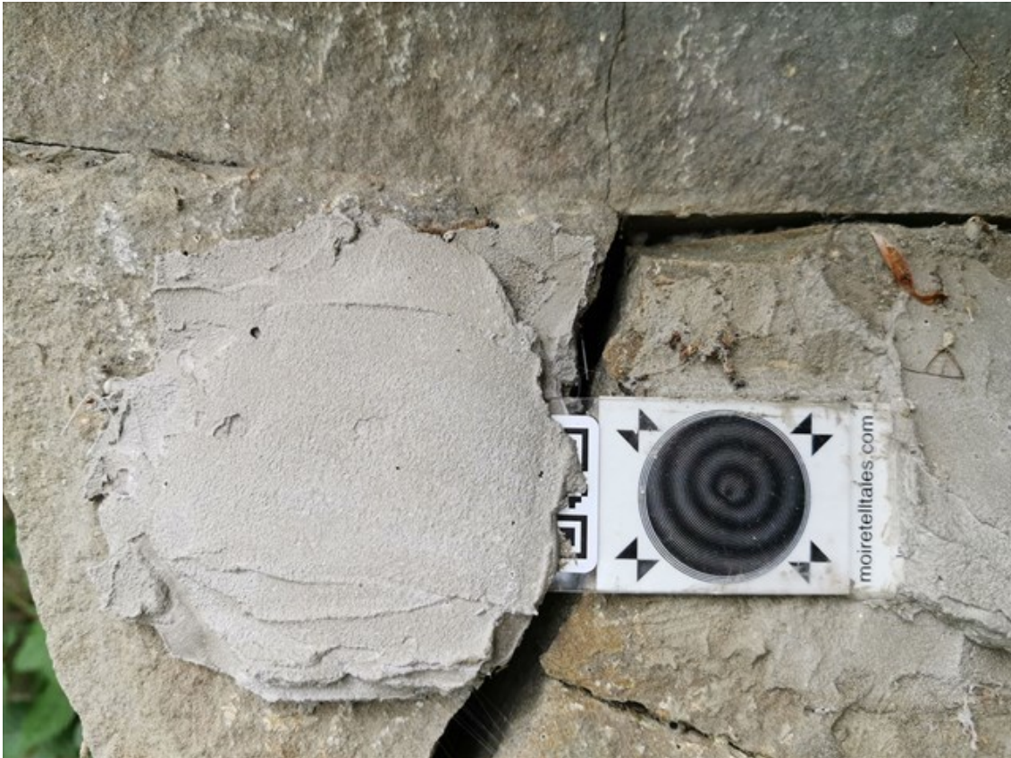
Obrázek 5 Sklíčka – fotografie pořízená hráčem hry Earthcaching ukazuje měřící sklíčka, která zaznamenávají pohyb skalních bloků oddělených puklinou.
